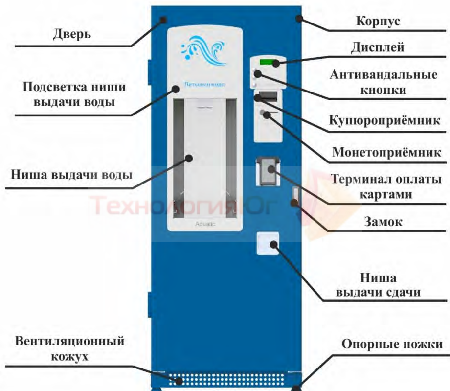
Рисунок 2 – Состав автомата снаружи Aquatic WA 400
