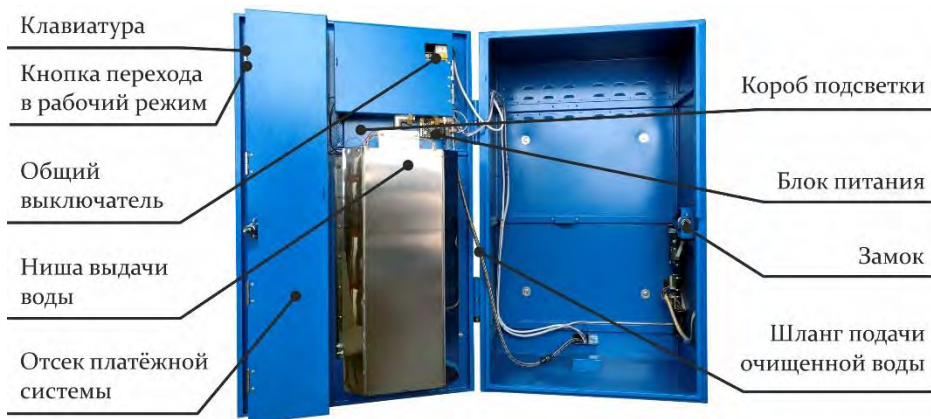
Рисунок 5 – Состав автомата внутри Aquatic WA 400 WALL
