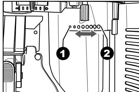
Машина позволяет выполнять плавную регулировку степени помола кофе, с тем чтобы она соответствовала типу используемого кофе. Регулировку следует выполнять с помощью рычага, расположенного сбоку внутри отсека для обслуживания машины.
