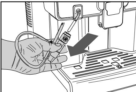
**10** Снимите всасывающую трубку с Cappuccinatore.
