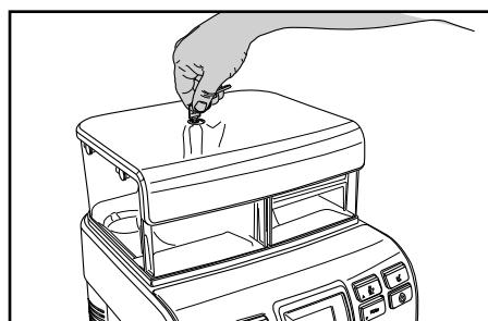
**2** После разблокирования поднимите и снимите крышку.
