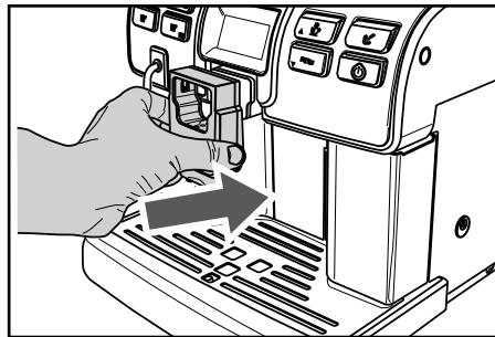
**25** Установите насадку Cappuccinatore на трубку пара.
