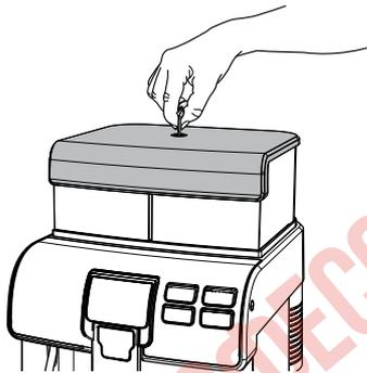
После разблокирования поднимите и снимите крышку.
