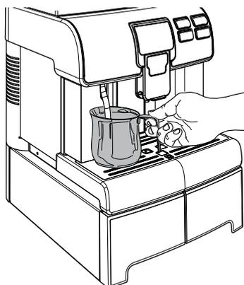
Нажмите кнопку «Горячая вода», чтобы включить подачу ГОРЯЧЕЙ ВОДЫ. По окончании подачи горячей воды опорожните емкость. Машина готова к использованию.
