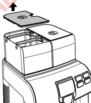
Достаньте бак; поднимите его при помощи специальных ручек, установленных внутри.
