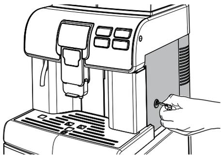
Достаньте блок приготовления кофе, для этого потяните за специальную ручку и нажмите кнопку «PRESS». Блок приготовления кофе можно мыть только теплой водой без моющего средства.
