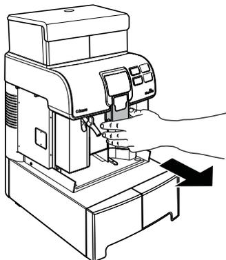
Снимите передний кожух, нажав по бокам, чтобы отсоединить крепежные фиксаторы.
