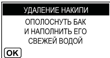
Тщательно ополосните бак и наполните его свежей питьевой водой. Вставьте бак в машину. Нажмите кнопку «Кофе». Опорожните емкости, использованные для сбора выходящей из машины жидкости.
