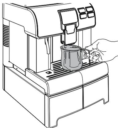
Нажмите кнопку «Кофе», чтобы начать подачу. Машина выполнит подачу кофе из устройства подачи; дождитесь завершения подачи и опорожните емкость. Повторите такие подачи 3 раза.
