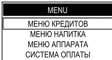
При помощи описанной процедуры осуществляется вход в меню программирования даже в том случае, если машина холодная и не достигла рабочей температуры; некоторые программы (напр.: УДАЛЕНИЕ НАКИПИ) машина осуществляет автоматически, выполняя нагрев согласно заданным производителем настроек.
