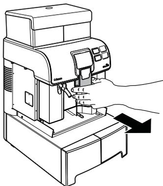
Установите проставку на левую сторону машины и закрепите ее 4 винтами из комплекта поставки.
