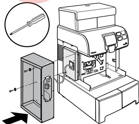
Шнур подключения должен быть специально заведен в ящик.
