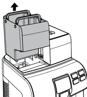
Ополосните и наполните бак свежей водой; не превышайте максимальный уровень (MAX), указанный на баке.
