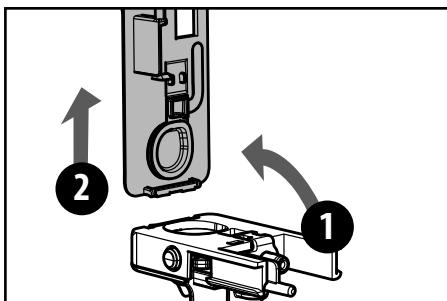
**13** Снимите соединение всасывающей трубы с Cappuccinatore.
