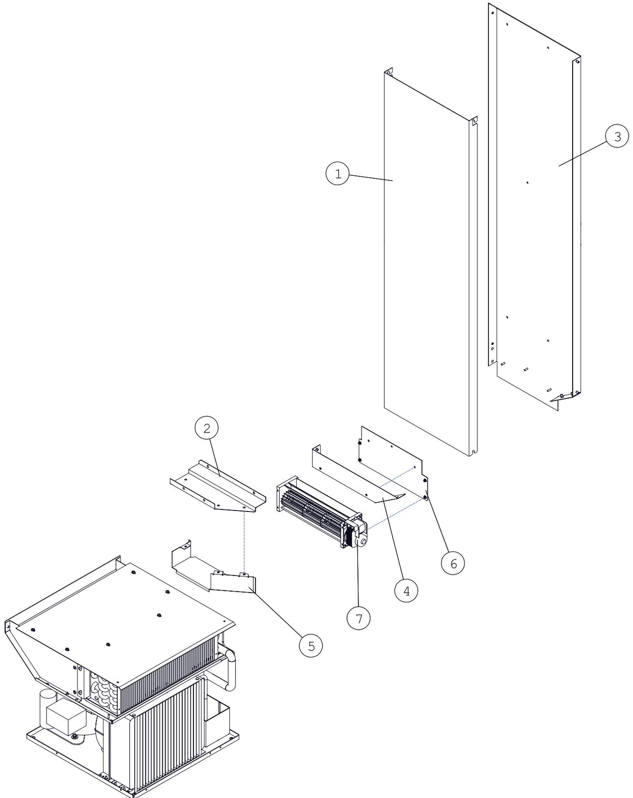
КОМПЛЕКТ СИСТЕМЫ ОХЛАЖДЕНИЯ С БОКОВЫМ ВОЗДУХОВОДОМ И ТАНГЕНЦИАЛЬНЫМ ВЕНТИЛЯТОРОМ / 16-1
